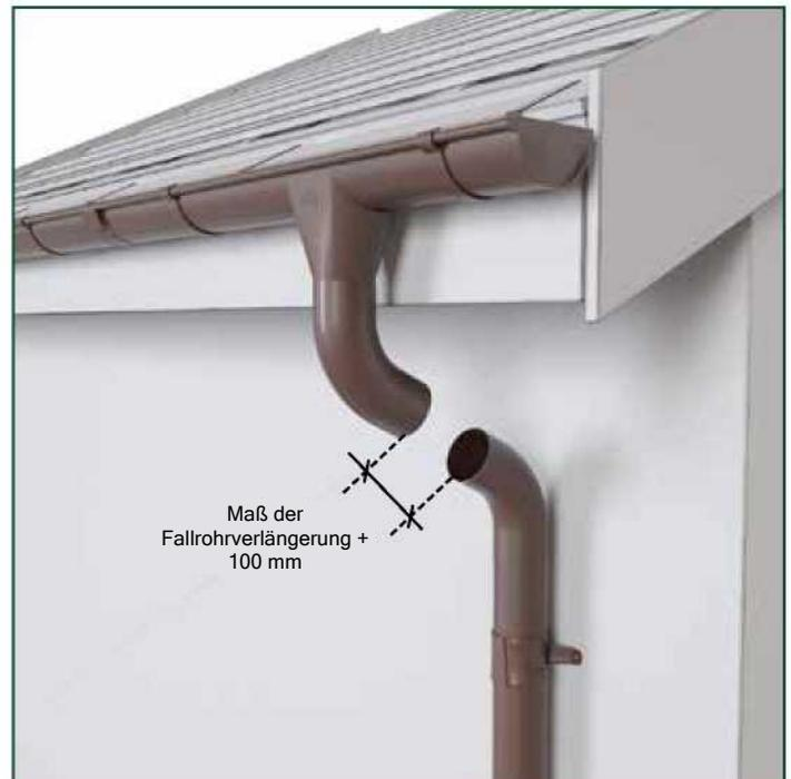
Die Fallrohrverlängerung muss 50 mm + 50 mm größer als das Maß zwischen den Bögen abgeschnitten werden.
